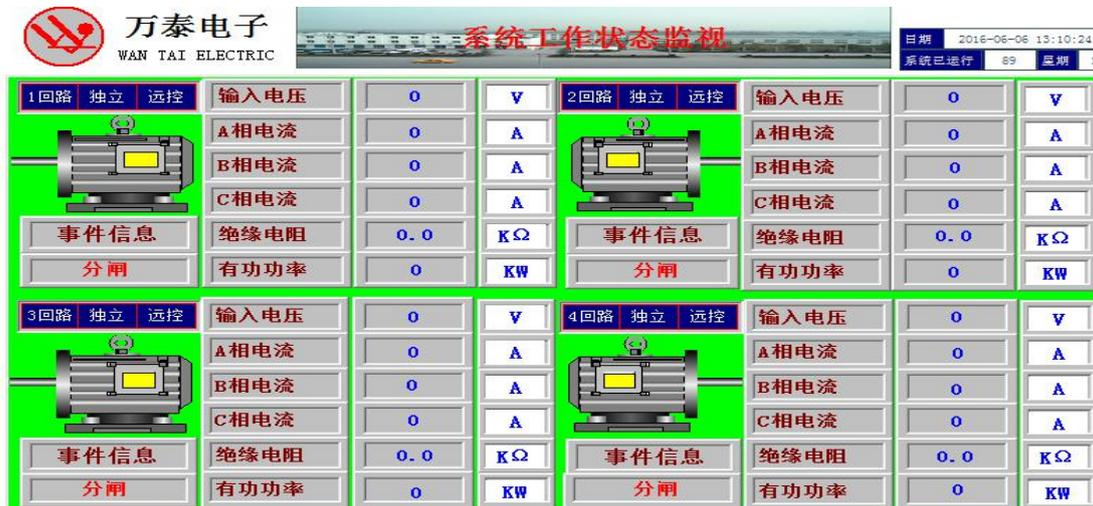
处于监控界面时，按下“下翻”进入参数设置界面（如图三），再按下“确认”键后输入密码，密码为最多六位，初始密码为“0”，输入密码后再按“确认”键即可进入“回路参数设置”界面，进行参数设置。字符闪烁表示为当前项，按“下翻”键保存参数并进入下一项。设置过程为：
